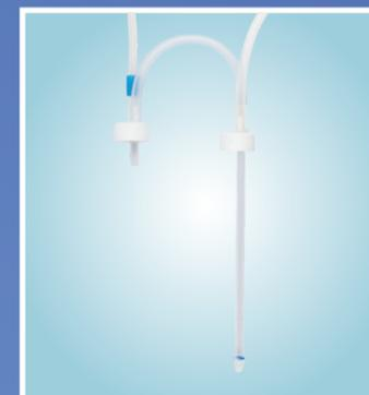
\* Ein Lippenventil an der Wasserschlossflasche dient als Rücklaufsicherung und Undichtigkeitsindikator
